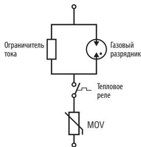
В случае сильного и кратковременного перенапряжения одновременно приводятся в действие газовый разрядник (GDT) и варистор (MOV). В случае длительного небольшого перенапряжения ограничитель тока ограничивает ток протекающий через варистор. Это технологическое решение обеспечивает повышение долговечности варистора. Наконец, другой особый механизм ограничителя, быстро гасит электрическую дугу на стадии срабатывания теплового реле.
